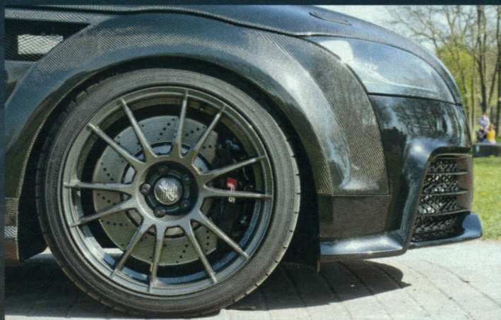
6-Kolben-Bremssättel und 390-mm-Bremsscheiben vom RS 6 sowie Fischer-Hydraulik Stahlflex-Bremsschläuche sorgen für optimale Verzögerungswerte
