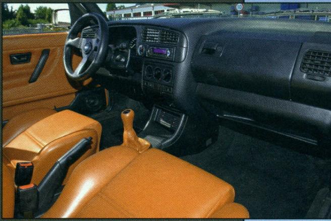
★ Armaturenbrett vom Golf 3, gekürzt und eingesetzt; höhenverstellbare Lenksäule, Ladedruckanzeige
