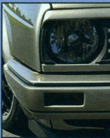
★ Dicke, gefüllerte und lackierte USA-Stoßstangen, Klarglasscheinwerfer in "Black Chrome"
